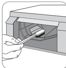
нижней части. Установите дозатор на место и выполните программу полоскания без белья в барабане.
