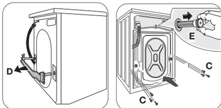
5. Снимите скобу **D**, закрутите шесть маленьких болтов **C** и снимите пластиковую шайбу **E**
