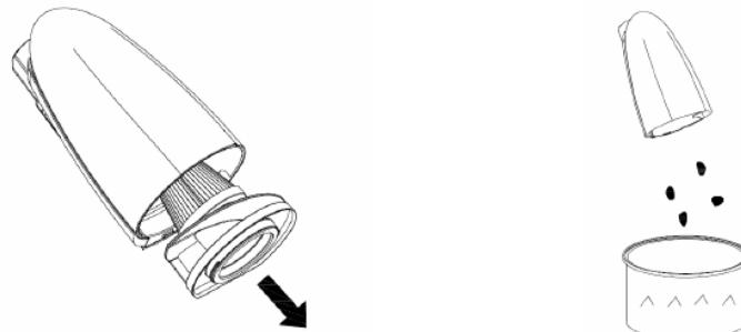
3. Zamontuj ponownie wszystkie elementy. Do pojemnika na zanieczyszczenia, należy umieścić filtr w ten sposób, aby dobrze przylgnął do pojemnika. Następnie włożyć pojemnik na zanieczyszczenia w odwrotny sposób, jak przy otwieraniu.
