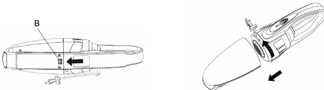
2. Wyjmij filtr i wyczyść zawartość pojemnika na zanieczyszczenia do odpowiedniego pojemnika lub kosza. Filtr można wytrzepać lub spłukać ciepłą wodą. Sprawdź, czy wszystkie elementy są suche przed ponownym montażem.
