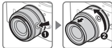
Draai aan de knop van de intrekbare objectiefcilinder (1) en draai de zoomring in de richting zoals weergegeven in figuur 2, om de zoomring te ontgrendelen en het objectief te verlengen voor gebruik. Door op de knop van de intrekbare objectiefcilinder te drukken en de zoomring naar de tegengestelde richting te draaien, kan het objectief worden ingetrokken en de zoomring worden vergrendeld.
