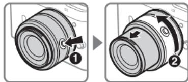
若要解除变焦环的锁定并伸出镜头以便使用，请按下可伸缩镜头镜筒按钮
