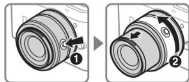
Para destravar o anel de zoom e estender a lente para o uso, pressione o botão de retração do tubo da lente (1) e gire o anel de zoom na direção mostrada na Figura 2. A lente pode ser retraída e o anel de zoom travado pressionando o botão de retração do tubo da lente e girando o anel de zoom na direção oposta.
