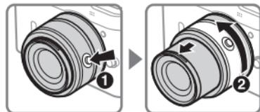
Pour déverrouiller la bague de zoom et sortir l'objectif afin de pouvoir l'utiliser, appuyez sur la commande de déverrouillage de l'objectif rétractable (1) et tournez la bague de zoom dans le sens indiqué dans la Figure 2. Vous pouvez rétracter l'objectif et verrouiller la bague de zoom en réappuyant sur la commande de déverrouillage de l'objectif rétractable et en tournant la bague de zoom dans le sens inverse.
