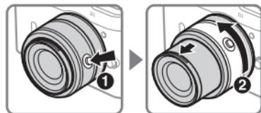
Um den Zoomring zu entsperren und das Objektiv an die Kamera anzusetzen, drücken Sie die Tubusentriegelung (1) und drehen Sie den Zoomring in die in der Abbildung (2) gezeigte Richtung. Das Objektiv kann nun eingezogen werden. Der Zoomring wird wieder gesperrt, indem die Tubusentriegelung betätigt und der Zoomring in die entgegengesetzte Richtung gedreht wird.
