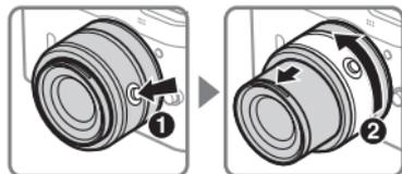
若要解除變焦環的鎖定並伸出鏡頭以便使用，請按下可伸縮鏡頭筒按鍵 (1) 並如圖 (2) 所示方向旋轉變焦環。按下可伸縮鏡頭筒按鍵並按相反方向旋轉變焦環即可伸縮鏡頭並鎖定變焦環。
