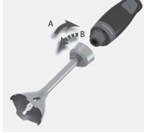
**2. Inserire l'albero di miscelazione** sull'impugnatura, girare in senso orario (A) e bloccarlo in posizione. Per rimuoverlo, girare l'albero di miscelazione in senso antiorario (B). L'apparecchio può essere utilizzato in modo continuo per 30 secondi. Successivamente, lasciarlo raffreddare per un minuto.
