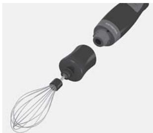
**7. Darbs ar tradicionālo putošanas slotiņu\*.** Lai savienotu putošanas slotiņu ar korpusu, grieziet korpusu pulksteņa rādītāja virzienā, līdz tā ir nostiprināta. Lai atvienotu, grieziet to pretēji pulksteņa rādītāja virzienam. Ierīci nepārtraukti drīkst izmantot 30 sekundes. Pēc tam ļaujiet tai 1 minūti atdzist.
