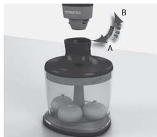
**6. Sätt fast mixerstaven på locket.** Skruva medsols (A) och lås fast. Sätt i kontakten och tryck på startknappen. Avbryt genom att släppa knappen. Vrid mixerstaven motsols för att ta loss den (B). Apparaten kan användas i upp till 30 sekunder i sträck. Låt svalna i en minut efter användning.
