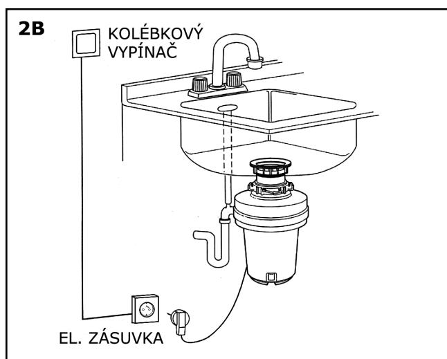
Alternativní variantou je použití nožního spínače nebo využití kompletu dálkového bezdrátového spínače s vlastní baterií a přijímače, kde odpadá nutnost dodatečného přivádění el. instalace a lze jej umístit prakticky kdekoli, aniž by došlo k porušení bezpečnostních předpisů. Spínač se jednoduše přisroubuje nebo přilepí na určené místo.
