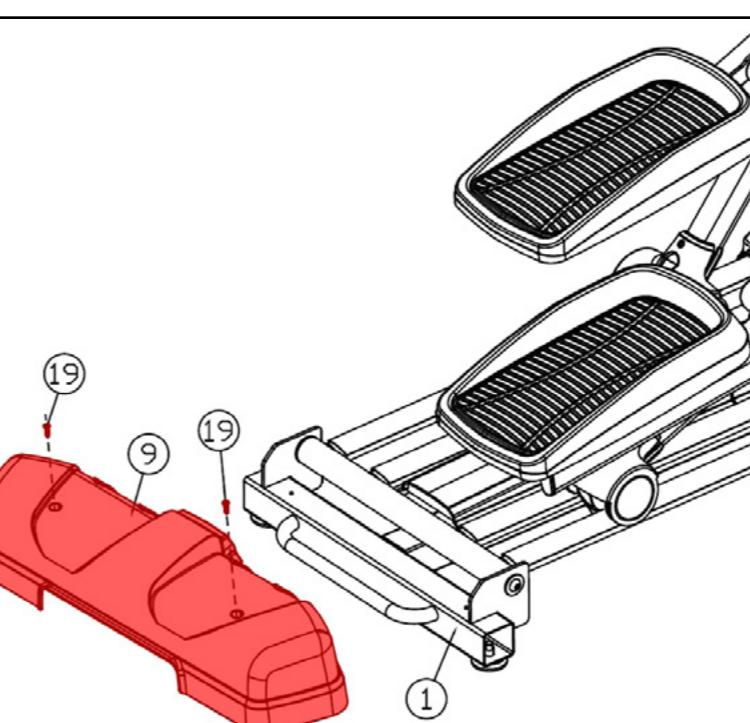
**Krok 3 - Montáž zadného plastového krytu stabilizátora**
