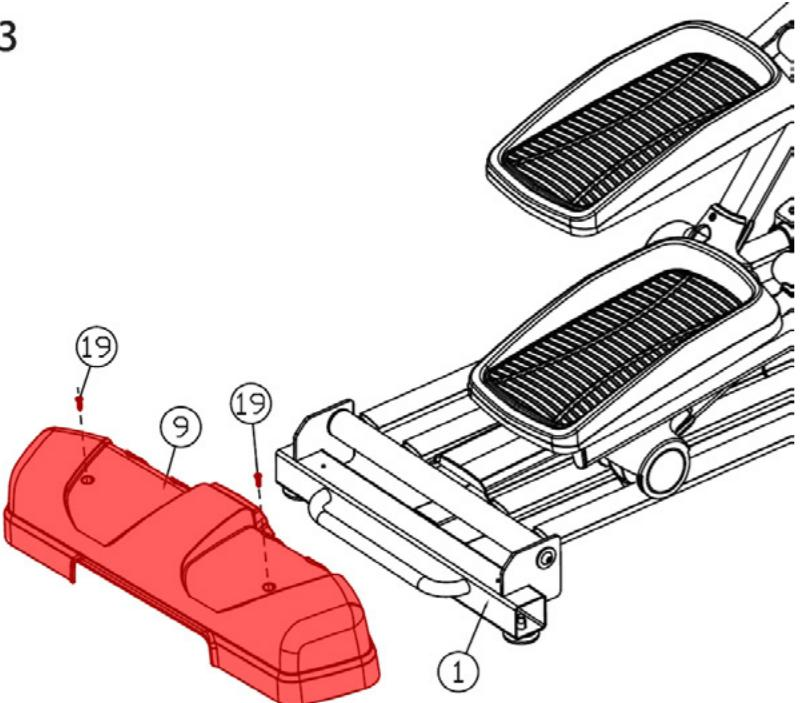
**Krok 3 - Montáž zadního plastového krytu stabilizéru**
