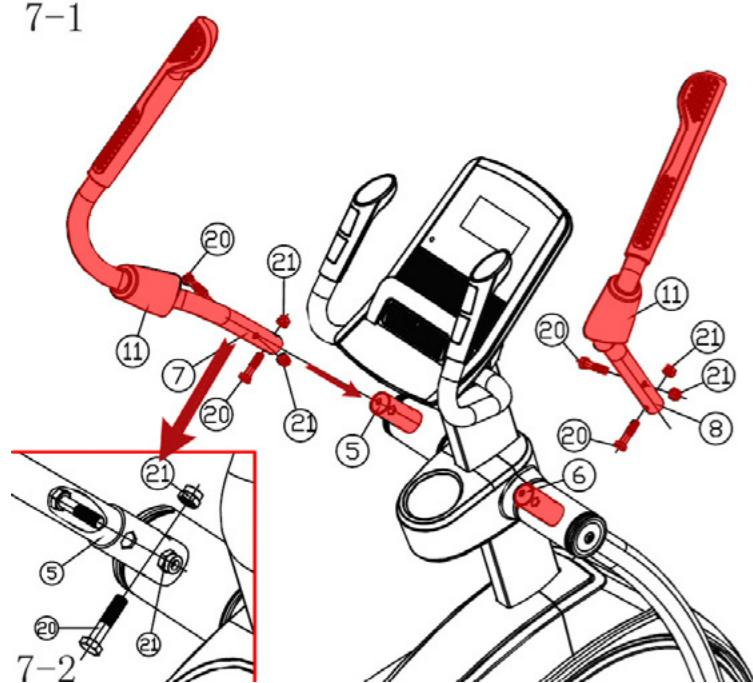
**Krok 7 - Montáž levého a pravého pohyblivého ramena**
