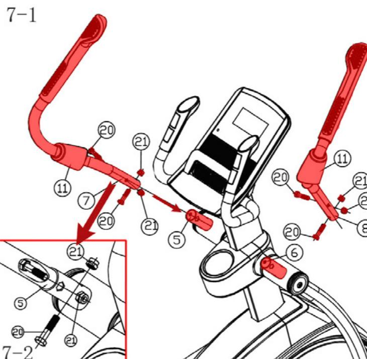
**Krok 7 - Montáž ľavého a pravého pohyblivého ramena**
