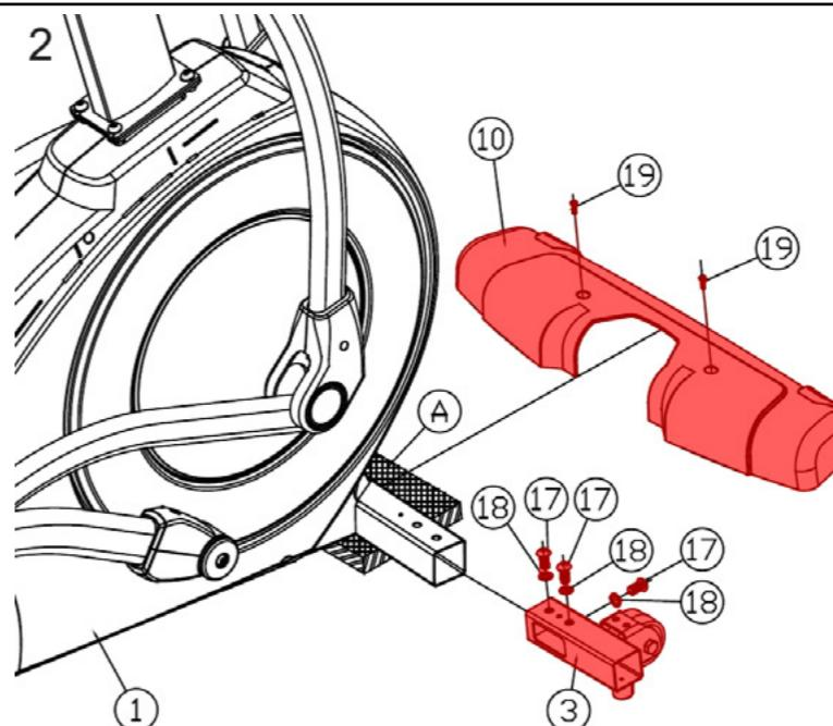
To samé udělejte i s levým stabilizérem na levé straně trenažéru. Až budete mít vše vše dotažené, tak odstraňte porpurný polystyren (A) pod hlavním rámem (1) a připevněte k rámu přední plastový kryt (10) prostřednictvím dvou šroubů # 8 - 18 x 16 mm (19), jak vykresluje obrázek č.2. Zkontrolujte, že vyrovnávače nerovnosti jsou správně nastavené k vaší podlaze. Překontrolujte, že pod trenažérem nejsou nečistoty nebo jiné předměty, které by mohly způsobovat nestabilitu trenažéru.
