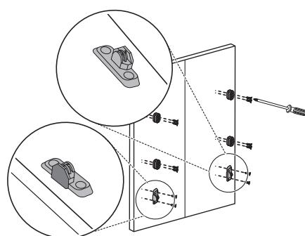
**6** Před montáží panelu na myčku připevněte na přední stranu panelu dvírek madlo. Nezapomeňte šrouby zapustit, aby se panel hladce posouval.
