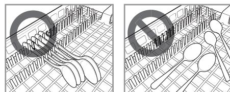
Pokud jsou rukojeti příborů příliš hrubé, pak je otočte tak, aby směrovaly opačným směrem.
