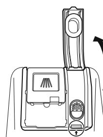
**2** Přidejte tekuté leštidlo po čáru maximálního naplnění. Leštido by se mělo při plnění usadit v dávkovači. V opačném případě mohou mít
