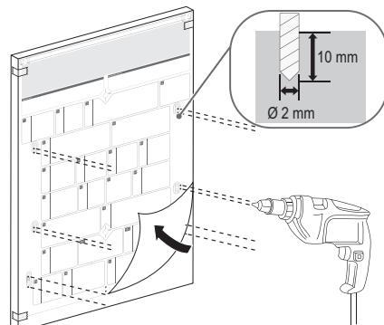
**(Případ B) Montáž pevného panelu**
