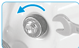
Uvolněte 4 přepravní šrouby pomocí klíče.
