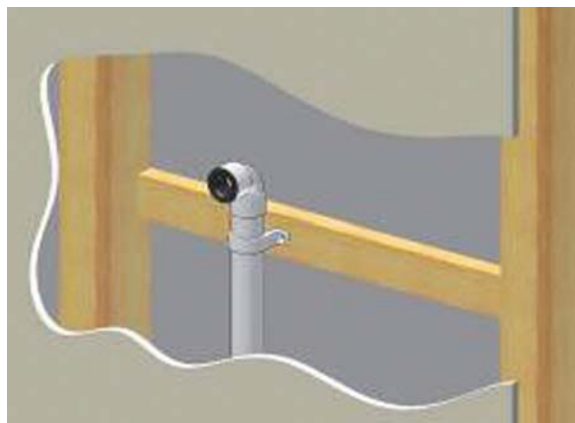
Obr. 15: Příprava připojení odvodu kondenzátu na svislý odpad
