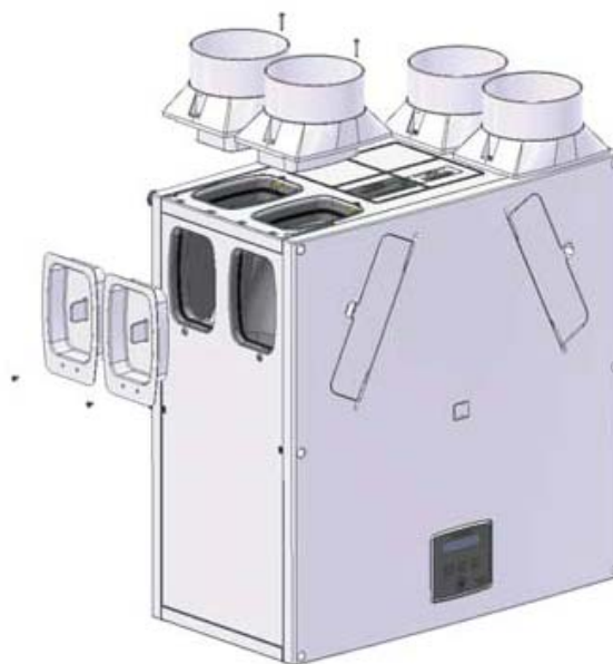
Obr. 18: Demontáž a instalace hrdel
