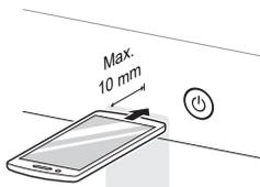
**3** Po dobu 3 sekúnd alebo dlhšie stlačte a podržte tlačidlo **Teplota** a zároveň držte mikrofón smartfónu pri tlačidle **Napájanie**, kým sa prenos dát neskončí.
