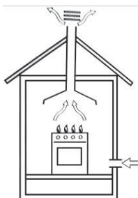
Vývod vzduchu do komína nebo větve komína (výlučně pro kuchyňské spotřebiče).
