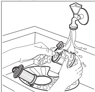
5. Zkontrolujte, zda ve sběrné jímnici nebo kolem ní nejsou žádné zbytky jídla a nečistot.
