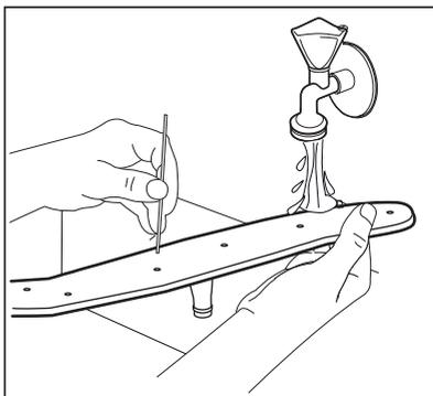
3. Dolní ostříkovací rameno nainstalujete zpět ztlačení ramene směrem dolů.
