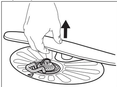
2. Ostříkovací rameno omyjte pod tekoucí vodou. Pomocí tenkého špičatého nástroje, např. párátko, odstraňte nečistoty z otvorů.
