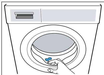
3. Nechejte dvírka spotřebiče a násypku na prací prostředky otevřené, aby mohla vyschnout zbytková voda.
