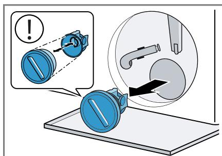
2. Vyčistěte vnitřní prostor, závit víčka čerpadla a těleso čerpadla.
