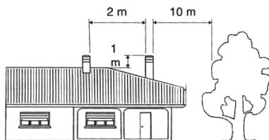
Rozměry komína můžou varírovat na základě jeho modelu. Ale, aby se zabezpečil dobrý průtok kouře, část otvoru pro vzduch při jeho konci vždy musí být o dvakrát větší než povrch kouřovodu, zatímco kryt komína nikdy nesmí bránit průtoku vzduchu.
